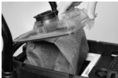
Abra a parte inferior soltando as duas travas laterais e remova a parte superior do aspirador:
